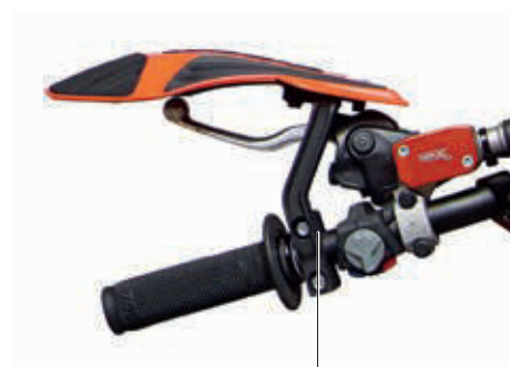
Nuovo sistema di montaggio al manubrio universale
